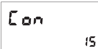
Рис 26. РЕЖИМ ПРОГРАММИРОВАНИЯ (Установка консерватизма) консерватизм 15%
