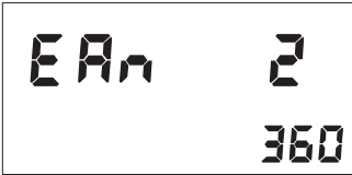
Рис 28. РЕЖИМ ПРОГРАММИРОВАНИЯ (режим пост. FO2) (Установка процентного содержания кислорода в деко-смеси) содержание 36%
