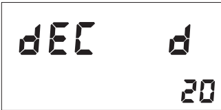
Рис 30. РЕЖИМ ПРОГРАММИРОВАНИЯ (режим пост. FO2) (Установка включения деко-смеси - активация по глубине) глубина 20футов
