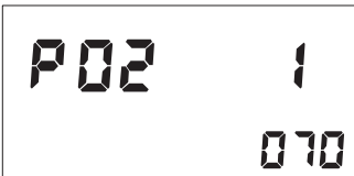
Рис 31. РЕЖИМ ПРОГРАММИРОВАНИЯ (режим пост. PO2) (Установка значения PO2) значение PO2 070атм
