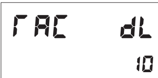
Рис 33. РЕЖИМ ПРОГРАММИРОВАНИЯ (Установка времени горения экрана) включен 10 сек.
