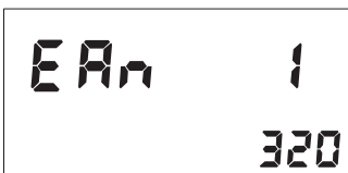
Рис 27. РЕЖИМ ПРОГРАММИРОВАНИЯ (режим пост. FO2) (Установка процентного содержания кислорода в смеси №1) содержание 32%
