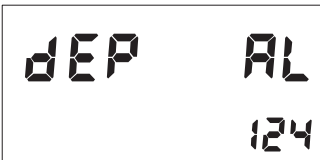
Рис 25. РЕЖИМ ПРОГРАММИРОВАНИЯ (установка сигнализации глубины) настроена на 124 фута
