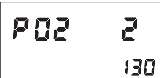
Рис 32. РЕЖИМ ПРОГРАММИРОВАНИЯ (режим пост. PO2) (Установка значения PO2 в деко-смеси) значение PO2 1,30атм
