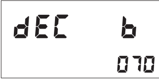
Рис 29. РЕЖИМ ПРОГРАММИРОВАНИЯ (режим пост. FO2) (Установка включения деко-смеси - временная активация) время погр. 70мин.
